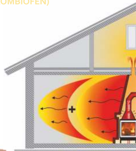
Terasest ja malmist südamik + CMA 770 kg (keraamilised soojustsalvestavad moodulid)
